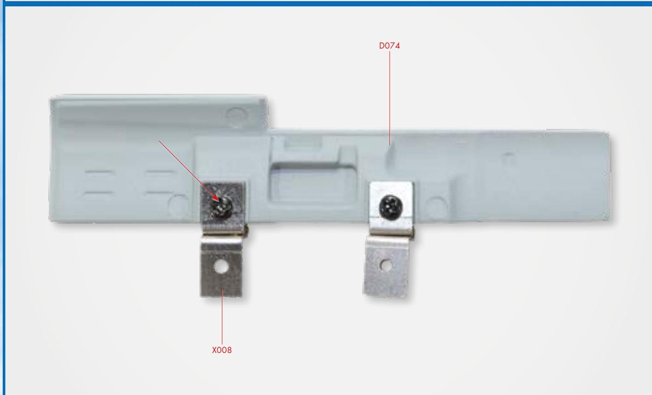
На этом этапе сборки вам потребуются детали, полученные с этим номером. Осторожно установите петли (X008) на створке (D074), как показано на снимках. А затем последовательно зафиксируйте детали с помощью винтов FM. Обратите внимание на взаимное положение петель и створки. При закручивании винтов не прилагайте особых усилий, чтобы не повредить детали и винты.
